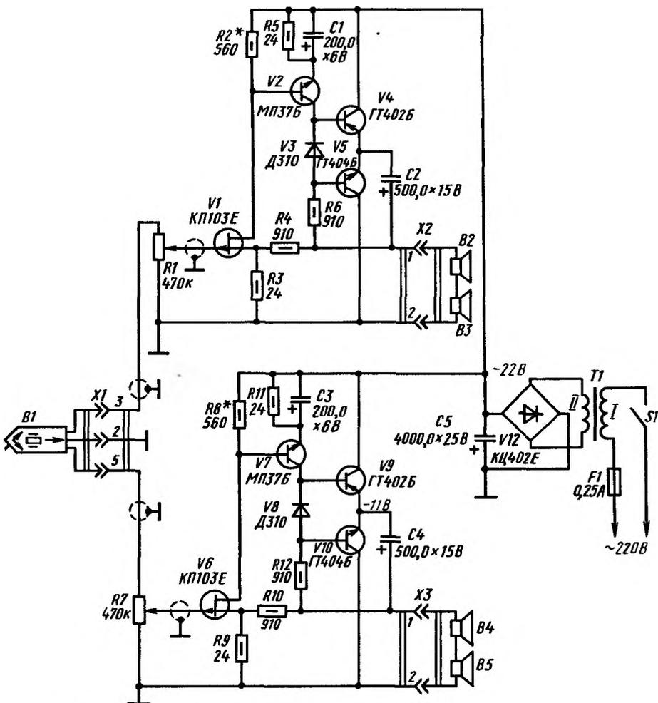
Рис. 318. Схема усилителя
