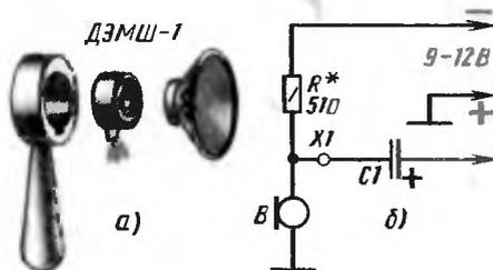
Рис. 195. Микрофон радиоула на базе капсюля ДЭМШ-1 (а) и схема включения угольного микрофона (б)
