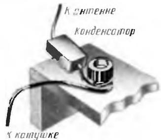
Рис. 31. Конденсатор, включенный в цепь антенны, улучшает селективность приемника
