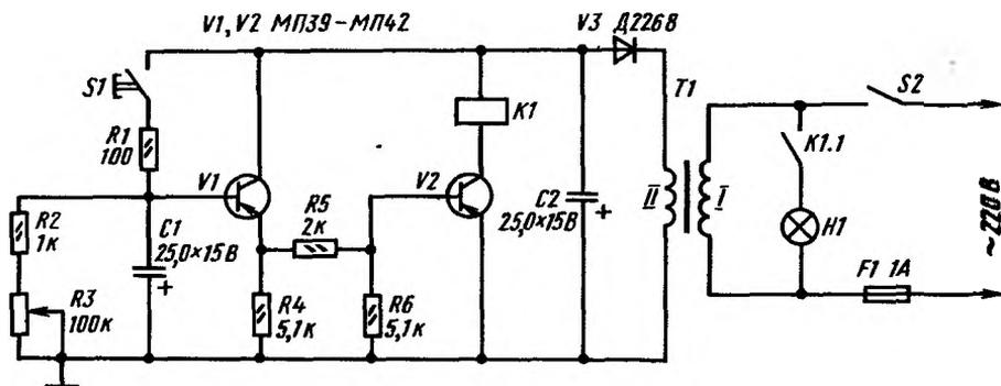
Рис. 259. Схема реле выдержки времени
