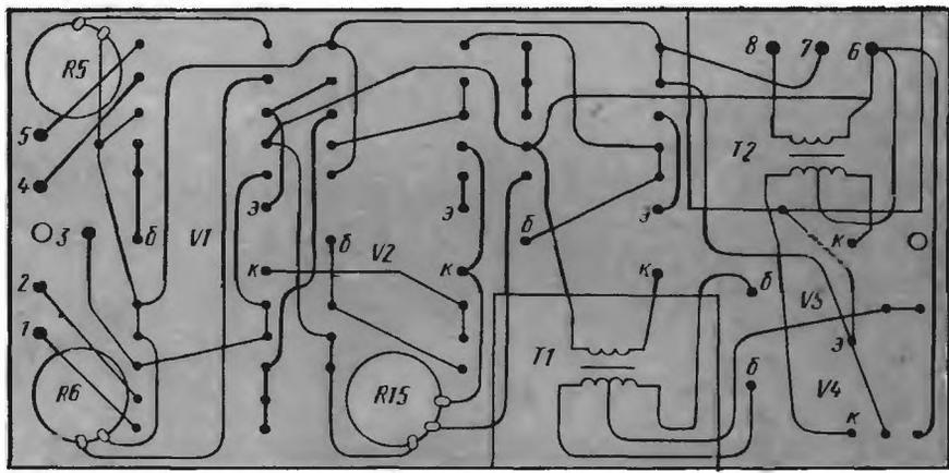
Рис. 353. Плата модулятора:
