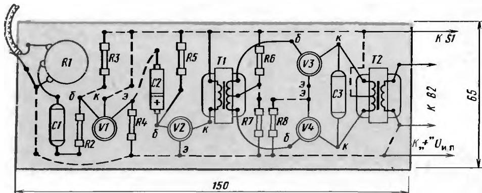
Рис. 184. Монтажная плата усилителя с повышенной выходной мощностью
