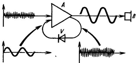
Рис. 98. Схема, иллюстрирующая принцип работы рефлексного приемника
