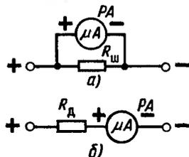
Рис. 109. Подключение шунта и добавочного резистора к электроизмерительному прибору PA
