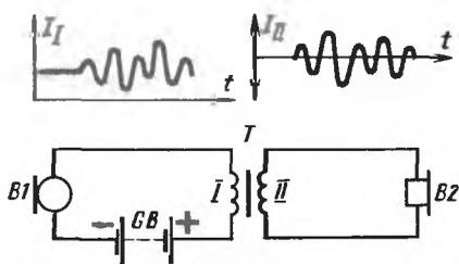
Рис. 152. Разделение тока цепи микрофона на его составляющие
