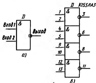
Рис. 303. Логический элемент 2И-НЕ (а) и микросхема 155ЛАЗ (б)
