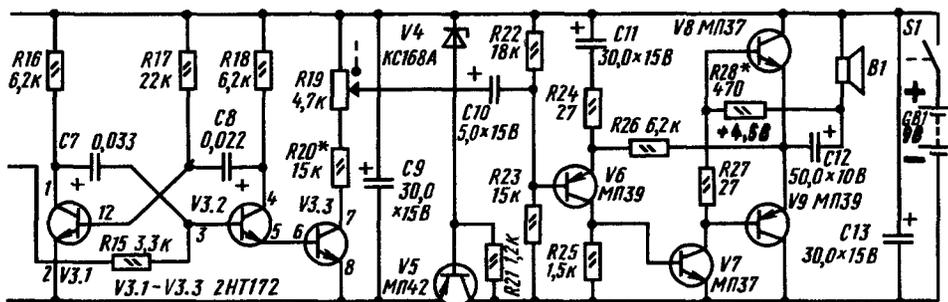
крепления платы в корпусе. Все резисторы типа МЛТ-0,125 (можно МЛТ-0,25), электролитические конденсаторы К50-6, переменный резистор R19 с выключателем питания S1—СПЗ—3В. Резисторы R6, R8, R9 и R10 смонтированы в вертикальном положении. Один из транзисторов сборки V3 (выводы 9—11) не используется.
