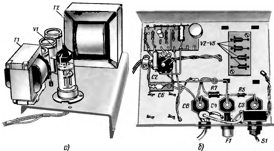
Рис. 226. Конструкция усилителя
