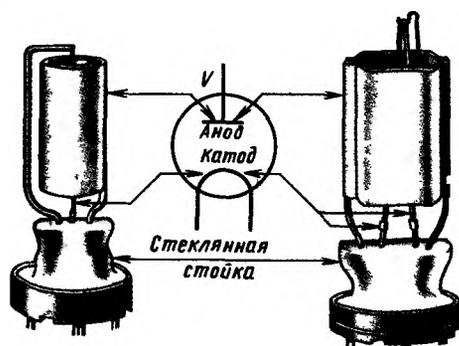
Рис 215 Устройство и изображение двухэлектродной лампы на схемах
