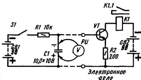
Рис. 258. Опыт, иллюстрирующий принцип работы реле выдержки времени
