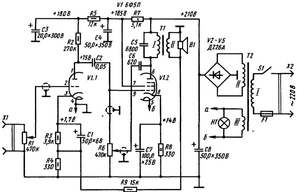
Рис 225. Принципиальная схема двухкаскадного усилителя на лампе 6Ф5П
