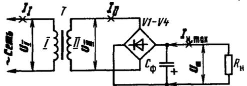
Рис. 166. Схема выпрямителя блока питания
