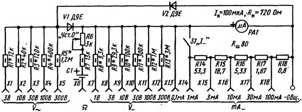
Рис. 116. Схема миллиампервольтметра
