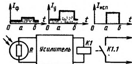
Рис. 254. Структурная схема фотореле, в котором функцию светочувствительного элемента выполняет фоторезистор
