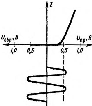
Рис. 374. Принцип действия кремниевого диода
