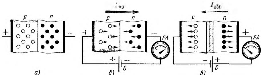
Рис. 74. Схематическое устройство и работа полупроводникового диода
