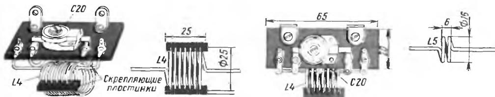
Рис. 356. Катушки усилителя мощности и их монтаж
