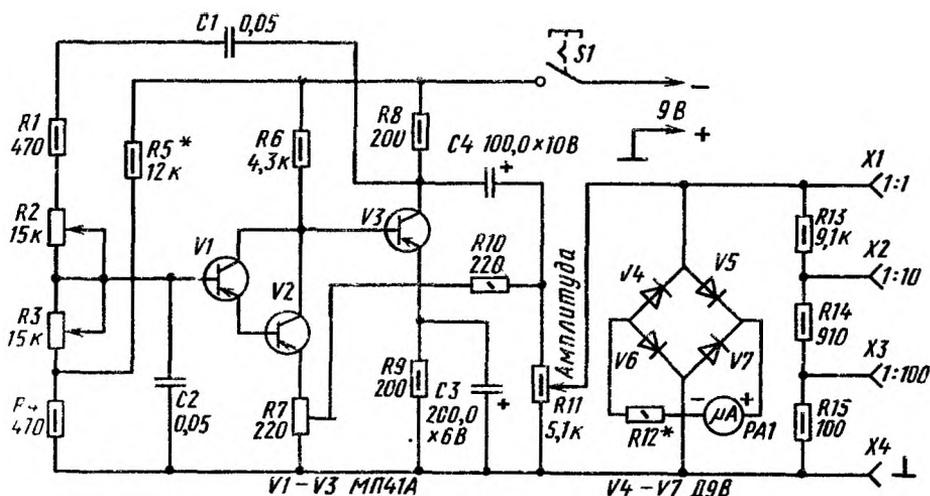
Рис. 291 Схема генератора с плавным изменением частоты
