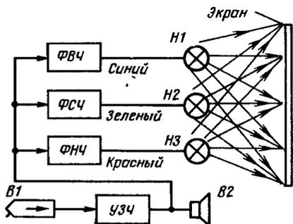
Рис. 334. Схема, иллюстрирующая суть цветомузыки
