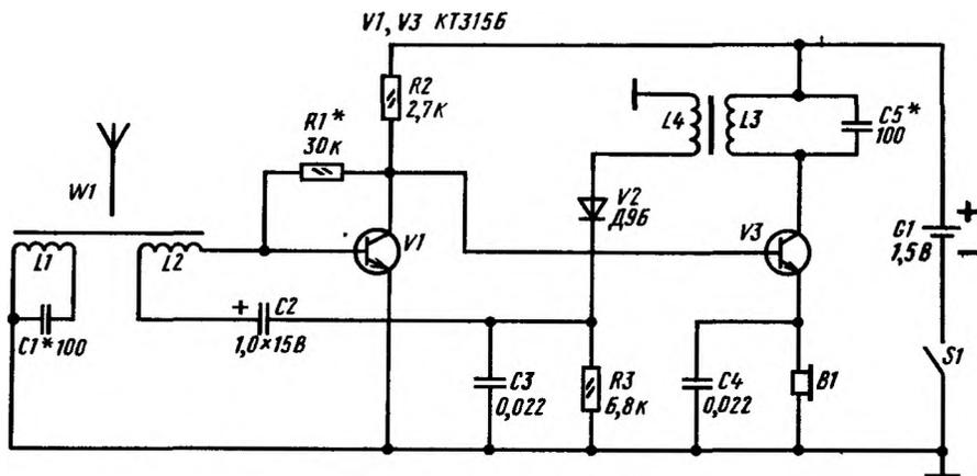
Рис. 210. Двухконтурный рефлексный приемник с низковольтным питанием
