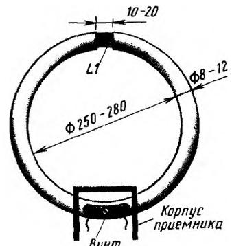
Рис. 372. Устройство рамочной антенны
