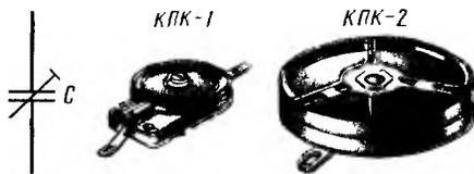
Рис. 69. Подстроечные конденсаторы и их схематическое обозначение
