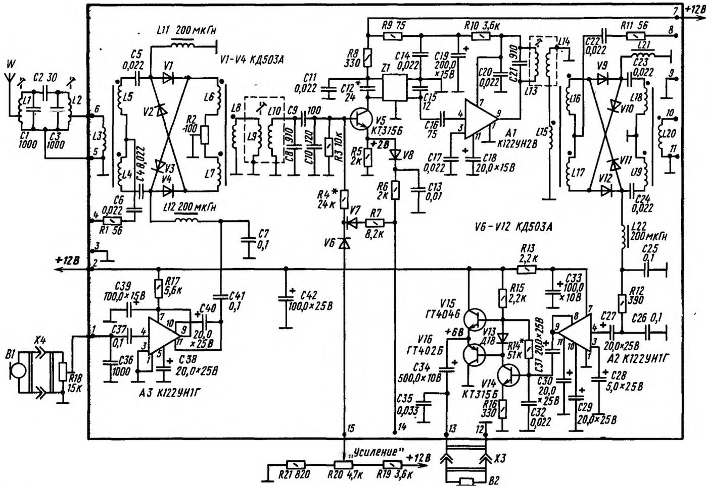
рый усиливается транзистором V5 первого каскада усилителя ПЧ. Предварительная фильтрация сигнала промежуточной частоты осуществляется колебательным контуром L10C8—C10, а основная—электромеханическим фильтром Z1, включенным в коллекторную цепь транзистора V5. Далее сигнал в тракте ПЧ усиливается микросхемой A1, представляющей собой каскодный усилитель.
