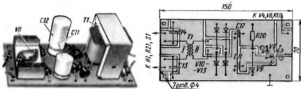
Рис 189. Внешний вид и плата блока питания усилителя
