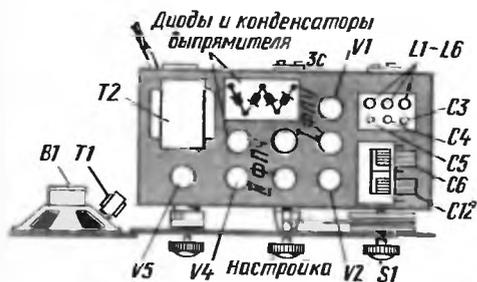
Рис. 242. Размещение деталей трехдиапазонного супергетеродина с каскадом усиления промежуточной частоты
