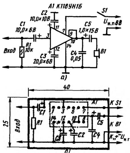
Рис. 296 Усилитель на микросхеме К118УН1Б
