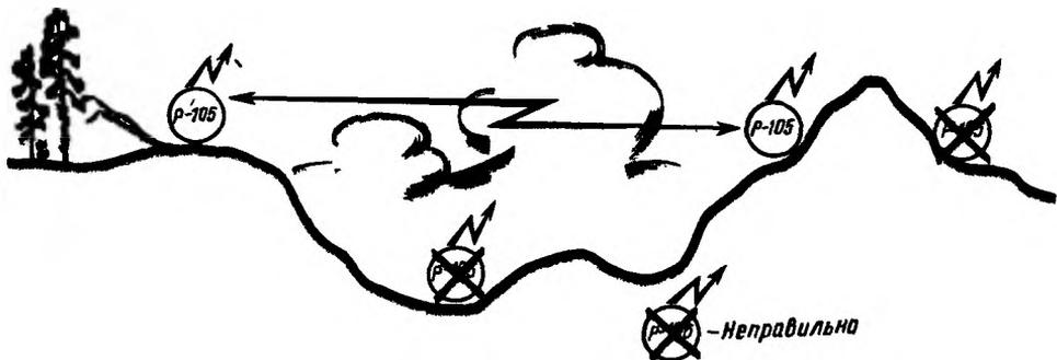
Рис. 407 Развертывание УКВ радиостанции в гористой местности
