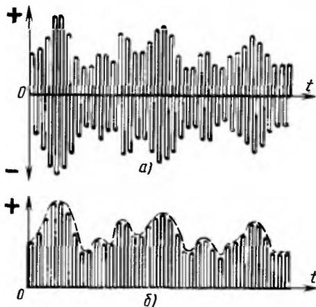
Рис. 45. Графики, иллюстрирующие детектирование модулированных колебаний радиочастоты
