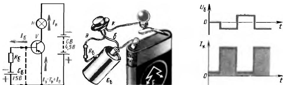
Рис. 88. Опыт, иллюстрирующий работу транзистора в режиме переключения
