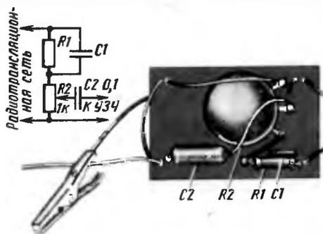
Рис. 104 Схема и конструкция делителя напряжения радиотрансляционной сети
