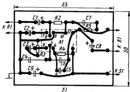
Рис. 302. Усилитель ЗЧ на микросхеме K174УН7
