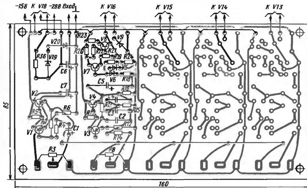
Рис. 340. Печатная плата и размещение деталей на ней
