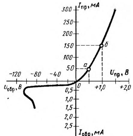
Рис. 75. Вольт-амперная характеристика полупроводникового диода
