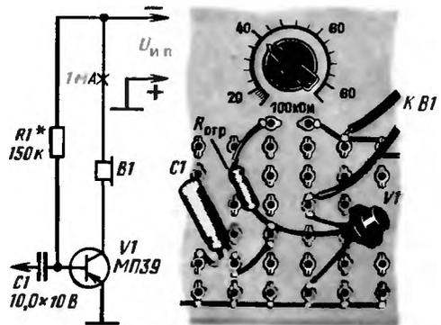
Рис. 148. Простейший усилитель, смонтированный на макетной панели
