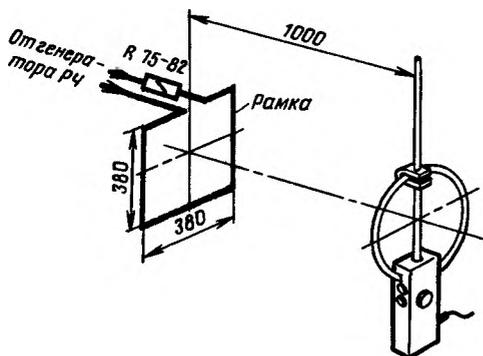
Рис. 381. Схема измерения чувствительности приемника по напряженности поля
