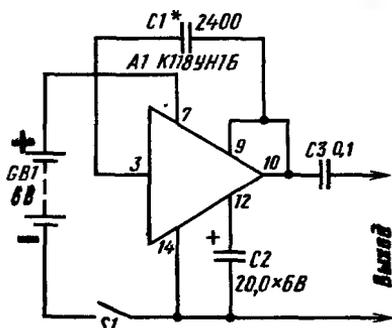
Рис. 297. Схема генератора колебаний звуковой частоты
