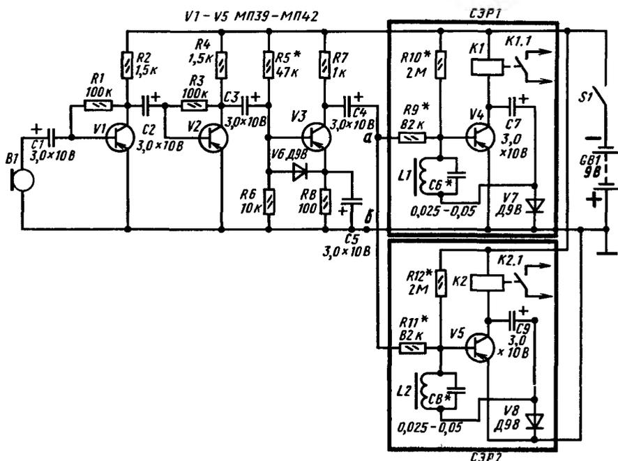
Рис. 344. Принципиальная схема двухкомандного приемника звукоуправляемой модели
