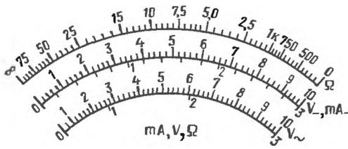
Рис. 120. Шкала миллиампервольтметра
