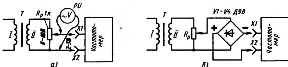
Рис. 289. Схема проверки и градуировки шкалы частотомера
