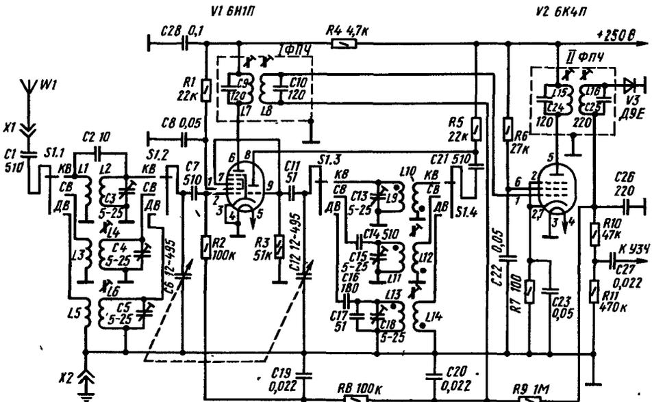
Рис. 240. Радиочастотная часть трехдиапазонного супергетеродина с АРУ
