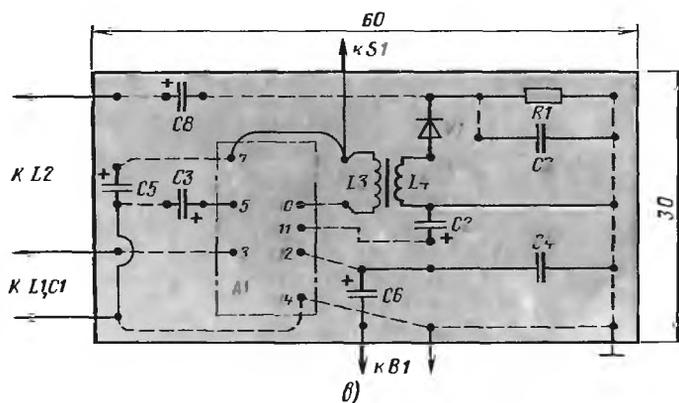
Рис. 298. Принципиальная схема (а), детали в развернутом виде (б) и монтажная плата (в) рефлексного приемника на микросхеме К118УН16
