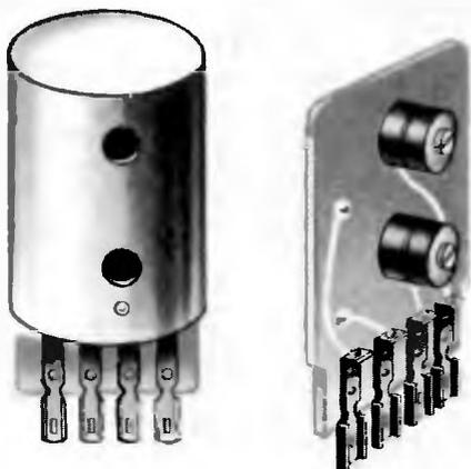
Рис. 238. Фильтр промежуточной частоты
