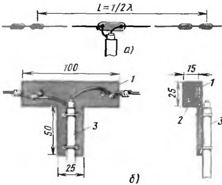
Рис 399. Антенна трансивера
