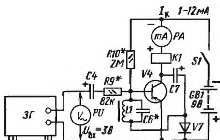
Рис. 348. Снятие частотной характеристики фильтра СЭР дешифратора
