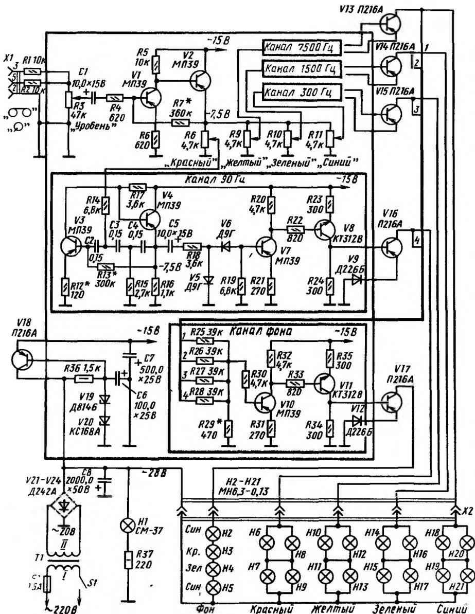
Рис. 337. Принципиальная схема светодинамической установки
