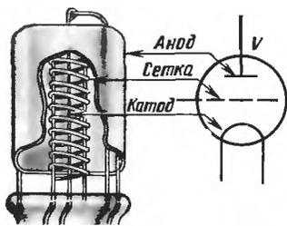
Рис. 216. Устройство и изображение триода на схемах
