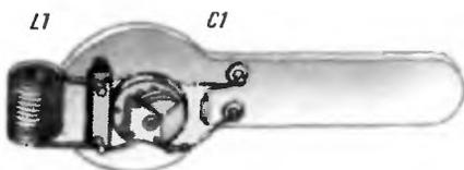
Рис. 357. Резонансный волномер
