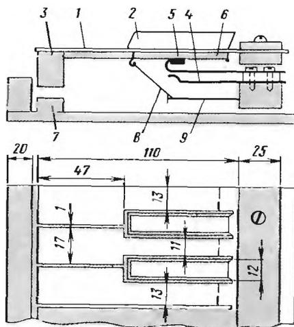
Рис. 330. Конструкция клавиатуры: 1 и 2—белая и черная клавиши; 3—подклавишный выступ; 4—контактные пружины; 5—прокладка (замша, сукно); 6—фанерная пластинка; 7—подклавишная прокладка; 8—шнурок; 9—гвоздь
