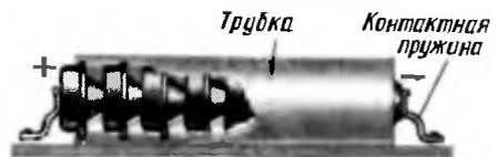
Рис. 164. Батарея, составленная из малогабаритных аккумуляторов
