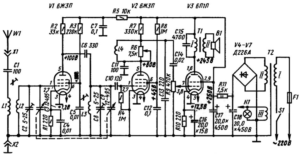
Рис. 228. Принципиальная схема приемника 1-V-1 на электронных лампах
