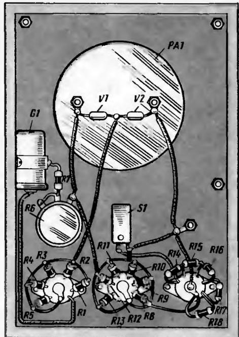
Рис. 117. Конструкция миллиампервольтметра
