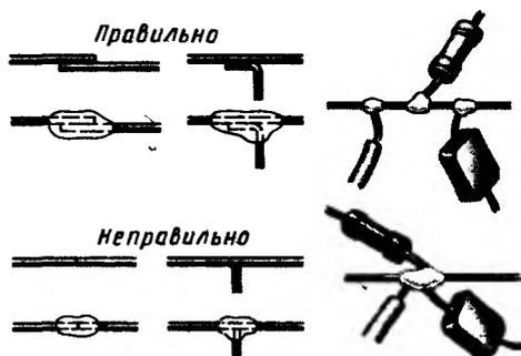
Рис. 130. Способы соединения проводников и деталей пайкой
