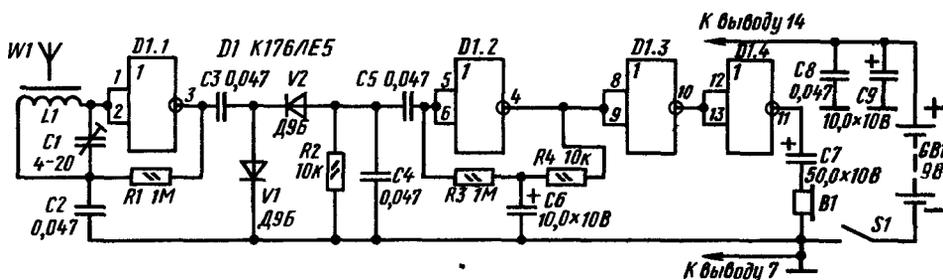
Рис. 308. Схема приемника прямого усиления на логической микросхеме
