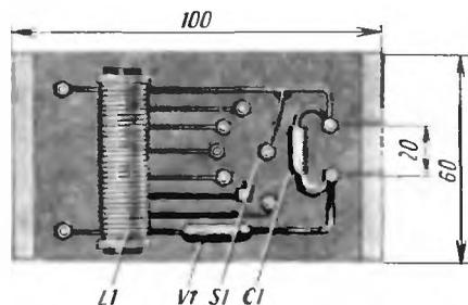
Рис. 35. Приемник с настройкой переключением секций контурной катушки
