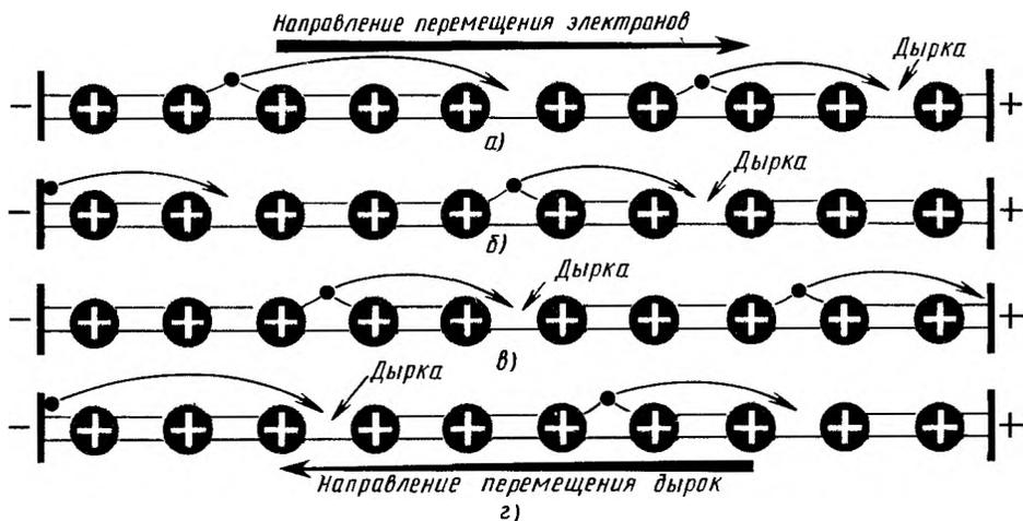
Рис. 73. Схема движения электронов и дырок в полупроводнике
