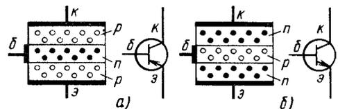
Рис. 83. Схематическое устройство и графическое изображение на схемах транзисторов структуры р-п-р и п-р-п
