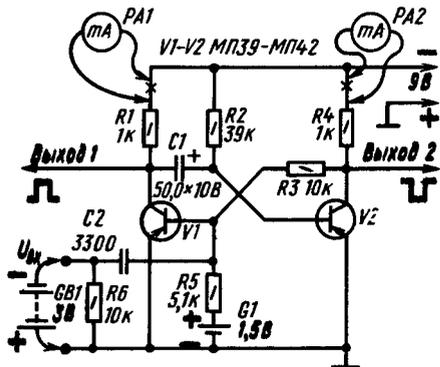
Рис. 269. Опытный ждущий мультивибратор
