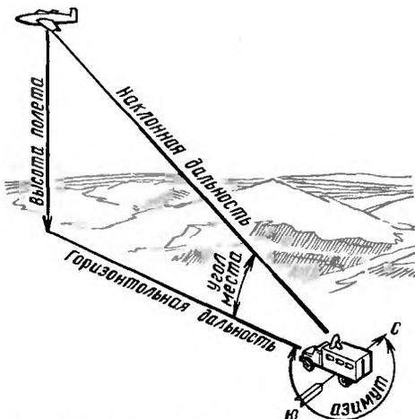
Рис. 414. Определение направления и высоты полета самолета
