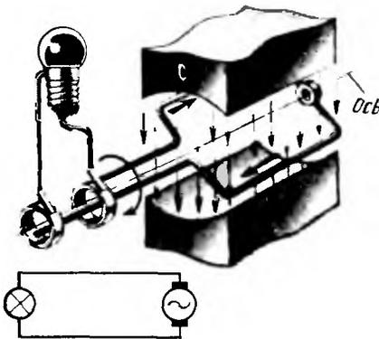
Рис. 13. Схема генератора переменного тока
