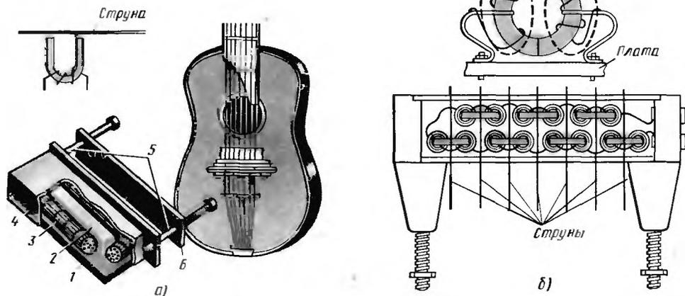
Рис. 333. Электромагнитный (а) и ферритовый (б) звукосниматели
