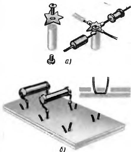
Рис. 131. Самодельные монтажная стойка (а) и монтажная планка (б)
