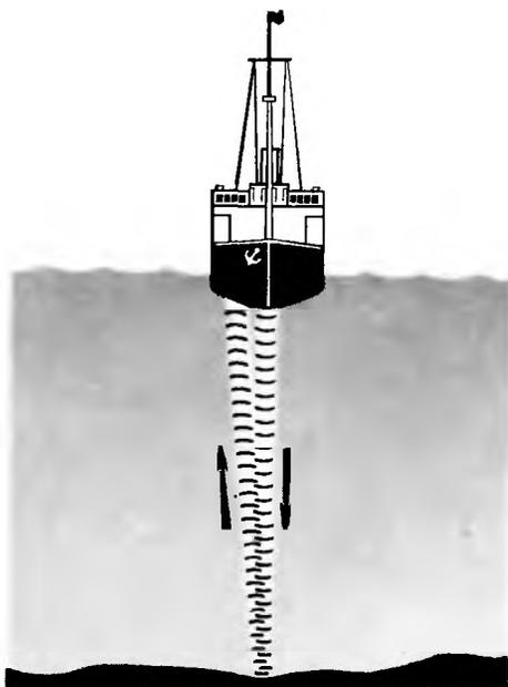
Рис. 410. Измерение глубины моря с помощью эхолота
