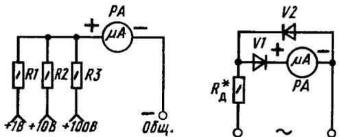
Рис. 112. Вольтметр постоянного тока на три предела измерений
