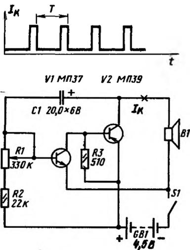
Рис. 272. Электронный метроном
