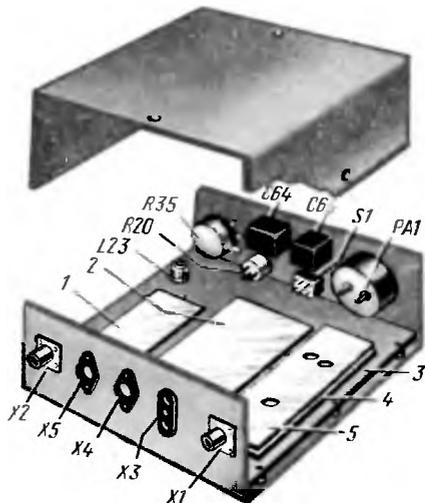
Рис. 395. Компоновка деталей и блоков трансивера в корпусе
