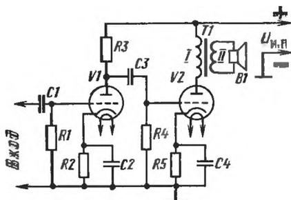
Рис. 224. Упрощенный двухкаскадный усилитель на электронных лампах
