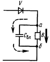
торной цепи высокочастотный пульсирующий ток разделяется (на рис. 48 — в точке а) на составляющие, которые далее идут: высокочастотная — через блокировочный конденсатор  $C_{бл}$ , а составляющая звуковой частоты — через телефоны В. Затем составляющие соединяются (на рис. 48 — в точке б) и далее опять идут вместе.
