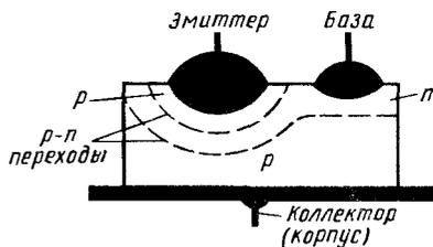
Рис. 85. Устройство диффузионно-сплавного транзистора структуры p-n-p
