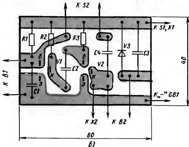
Рис. 178. Конструкция самодельной микроустройственной трубки (а) и плата усилителя телефонного аппарата (б)
