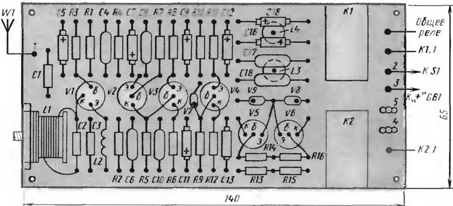
Рис. 362. Монтажная плата приемника (вид со стороны деталей)
