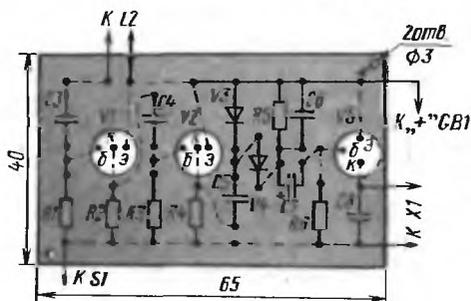
Рис. 369. Монтажная плата приемника-пеленгатора и схема соединения деталей
