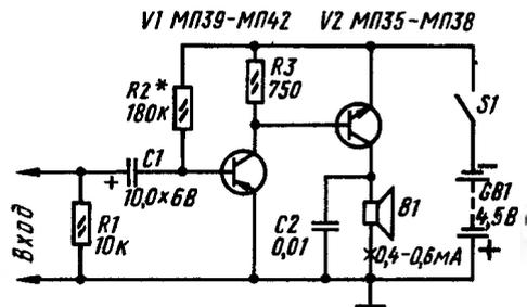
Рис. 175. Усилитель на транзисторах разной структуры
