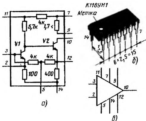
Рис. 295 Схема (а), конструкция (б) и условное обозначение (в) микросхемы К118УН1
