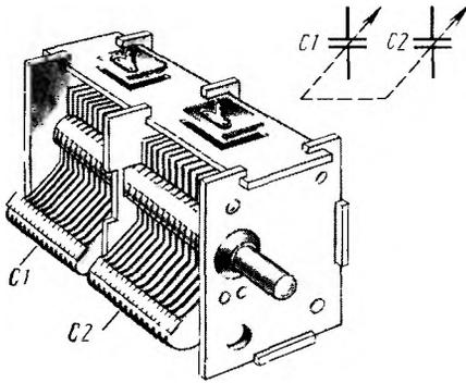
Рис. 68. Одна из конструкций блока конденсаторов переменной емкости
