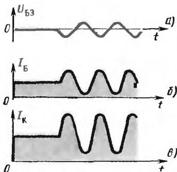
Рис. 89. Опыт, иллюстрирующий работу транзистора в режиме усиления
