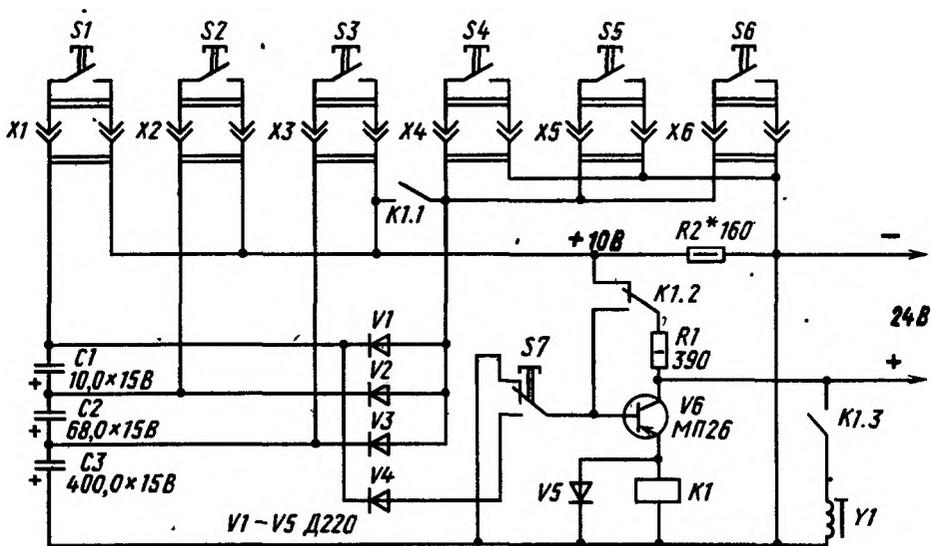
Рис. 264 Схема кодового замка с емкостной «памятью»
