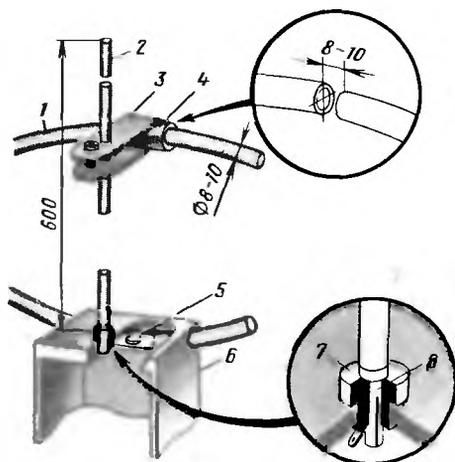
Рис. 379. Детали антенны приемника
