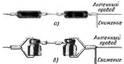
Рис. 24. Цепочки изоляторов
