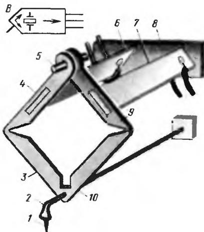
Рис. 312. Устройство и графическое изображение пьезокерамического стереофонического звукоснимателя
