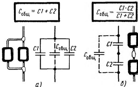
Рис. 70. Параллельное (а) и последовательное (б) соединения конденсаторов
