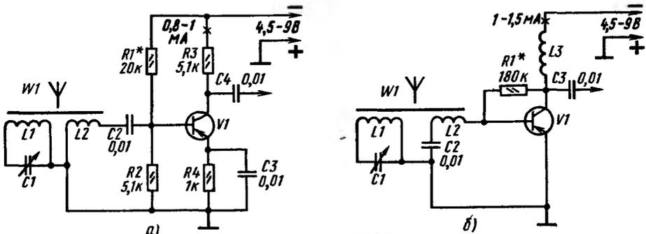
Рис. 200. Однокаскадный усилитель РЧ с магнитной антенной
