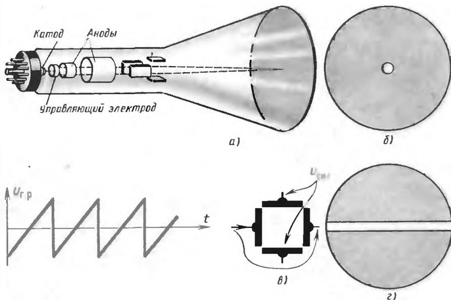
Рис. 412. Устройство и принцип действия электронно-лучевой трубки
