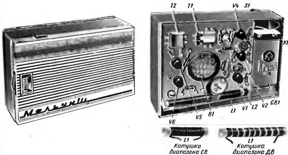
Рис. 213. Внешний вид и конструкция приемника «Мальчиш»
