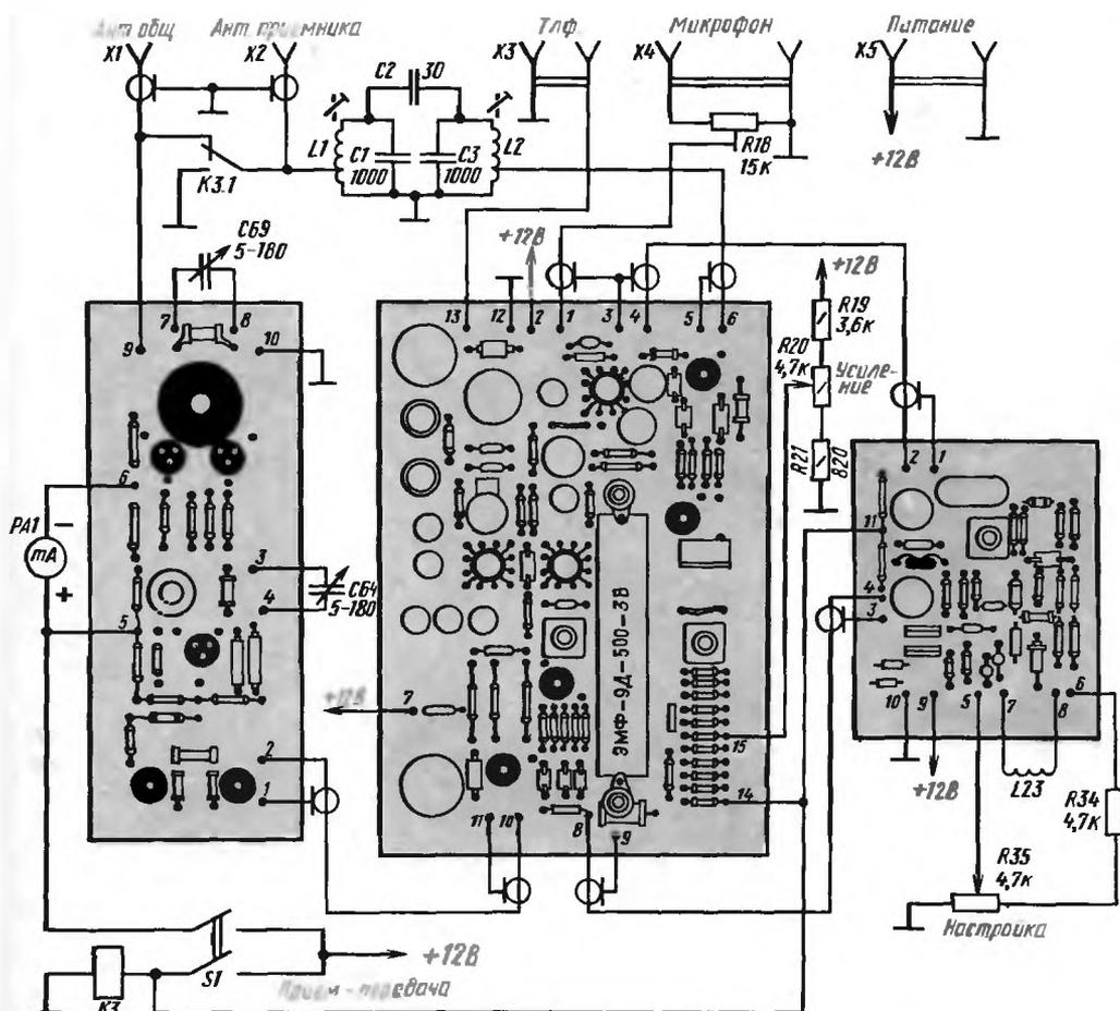
Рис. 391. Схема соединения блоков и деталей трансивера
