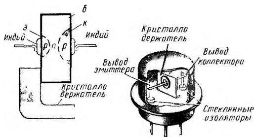
Рис. 84. Устройство и конструкция сплавного транзистора структуры p-n-p
