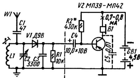
Рис. 92. Детекторный приемник с однокаскадным усилителем 3Ч
