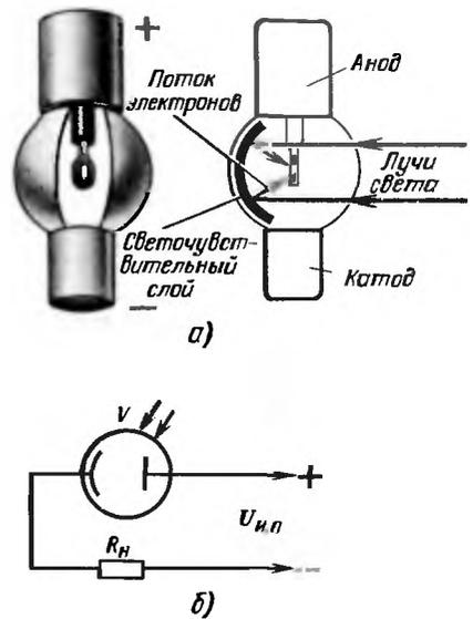
Рис. 245. Газонаполненный фотоэлемент ЦГ-3 (а) и его включение в электрическую цепь (б)
