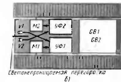
Рис. 341. Принципиальная схема (а) и схема размещения узлов аппаратуры светууправления (б) на модели танка
