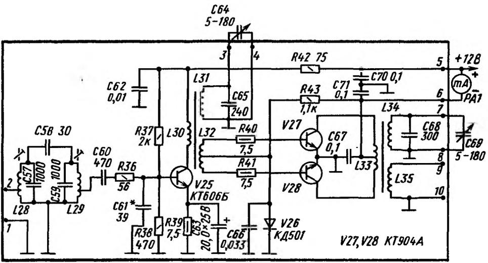
Рис. 390. Схема усилителя мощности
