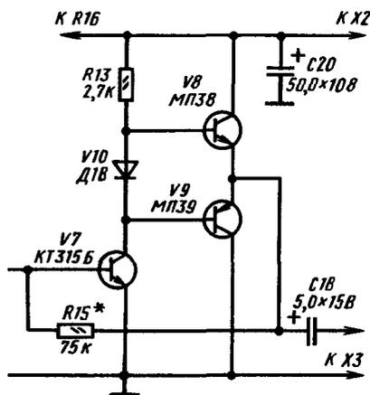
Рис 383 Схема выходного каскада приемника на германиевых транзисторах
