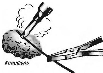
Рис. 128. Залуживание проводника
