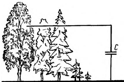
Рис. 43. Антенна и заземление — открытый колебательный контур
