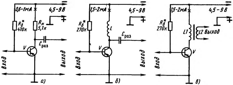
Рис. 199. Каскады усиления радиочастоты на транзисторах структуры p-n-p (для транзисторов структуры p-p-p полярность источника питания должна быть изменена на обратную)
