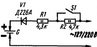
Рис. 165. Бестрансформаторный выпрямитель для зарядки дисковых аккумуляторов
