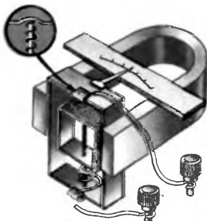
Рис. 106. Модель прибора магнитоэлектрической системы
