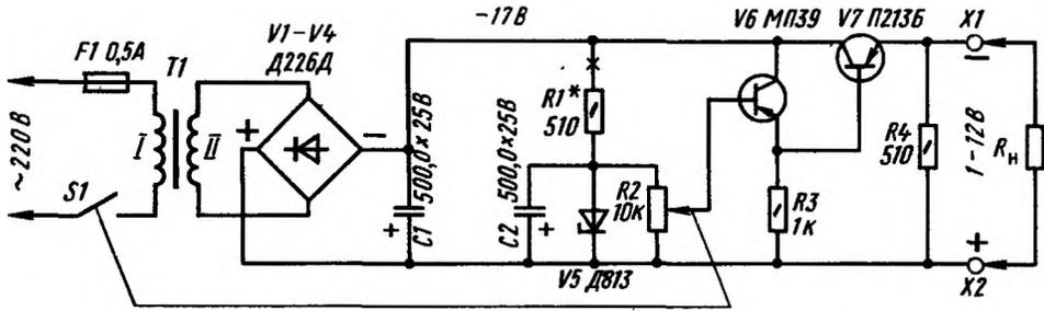
Рис. 169. Принципиальная схема блока питания транзисторных конструкций
