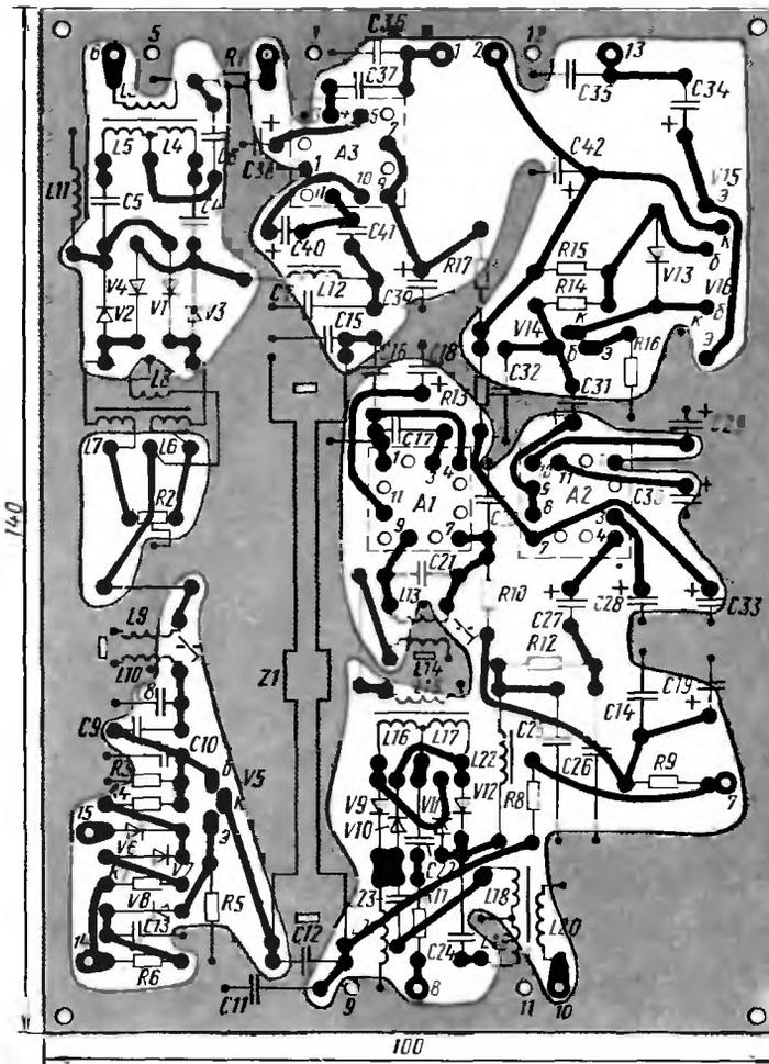
а транзистора V22 не менее 30 (при токе коллектора 20 мА). Через транзистор V22 протекает ток 15-20 мА, поэтому его желательно снабдить простейшим теплоотводящим радиатором. Транзисторы ГТ404Б (V15) и ГТ402Б (V16) можно заменить маломощными транзисторами МП41 и МП38. Но в этом случае к выходу усилителя ЗЧ основного блока (к разъему X3) можно будет подключать лишь головные телефоны.
