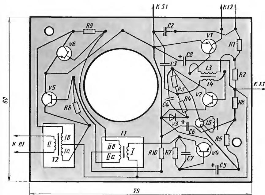
Рис. 214. Монтажная плата и соединения деталей на ней
