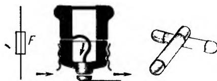
Рис. 71. Плавкие предохранители
