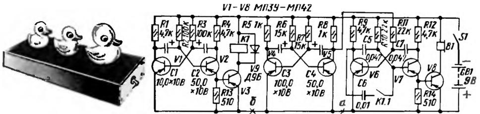
Рис. 274. Внешний вид и принципиальная схема «Утка с утятами»
