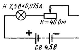
Рис. 54. Регулирование тока в цепи с помощью резистора
