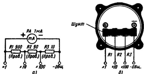
Рис. 111. Миллиамперметр с универсальным шунтом
