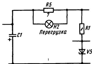
Рис. 172. Введение в блок питания сигнализатора перегрузки
