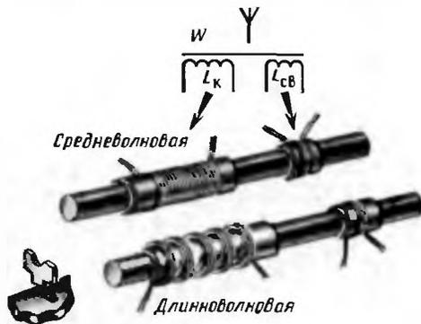
Рис. 201. Контурная катушка магнитной антенны с катушкой связи
