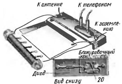
Рис. 30. Настройка приемника самодельным конденсатором переменной емкости
