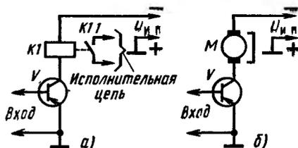
Рис. 253. Схема электронного реле
