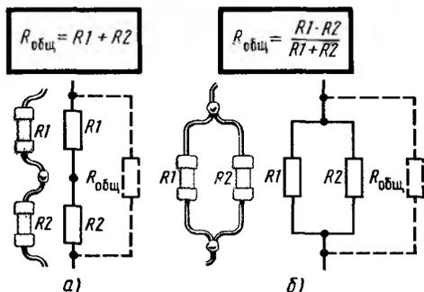
Рис. 61. Последовательное (а) и параллельное (б) соединения резисторов
