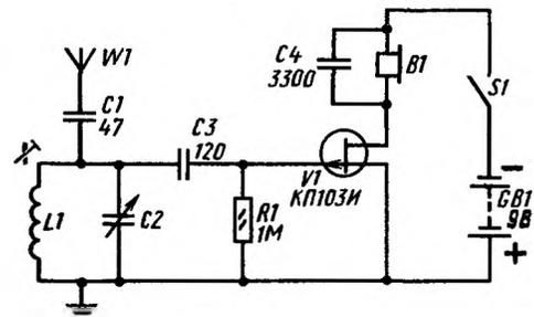
Рис. 97. Схема приемника на полевом транзисторе
