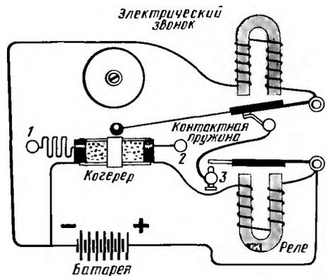
Рис. 15. Эскизный чертеж приемника А. С. Попова
