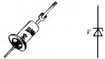
Рис 81 Стабилитрон и его графическое обозначение на схемах
