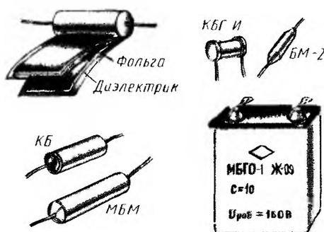
Рис. 64. Бумажные и металобумажные конденсаторы постоянной емкости
