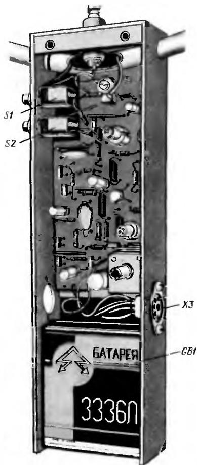
Рис. 378. Конструкция приемника
