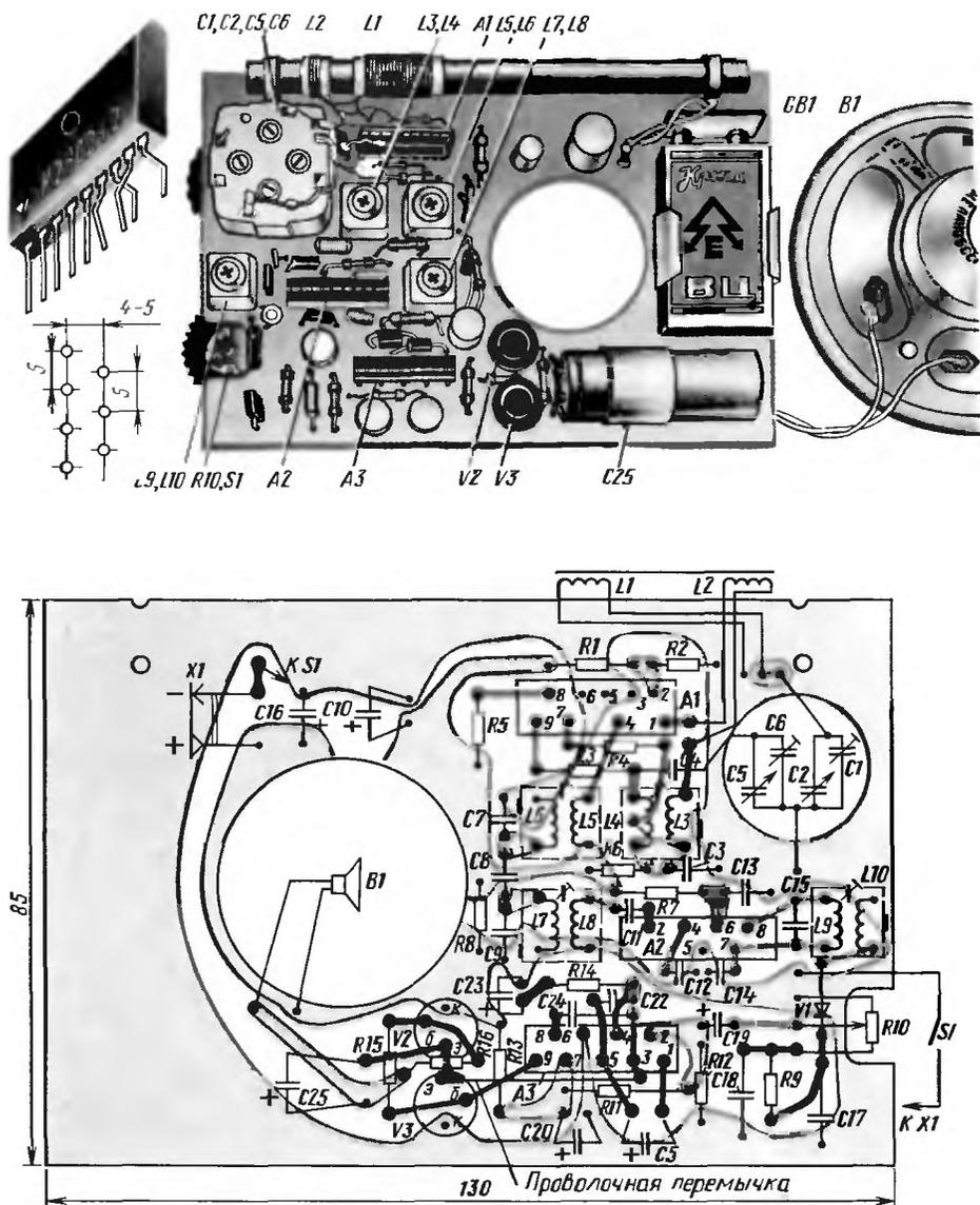
Рис. 301. Монтаж деталей, разметка токонесящих проводников печатной платы и схема соединений на ней
