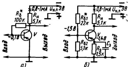
Рис. 179. Усилительные каскады с термостабилизацией режима работы транзисторов
