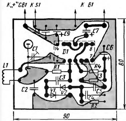
Рис. 309. Плата приемника
