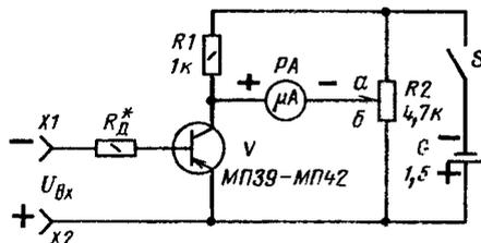
Рис. 285 Опытный вольметр
