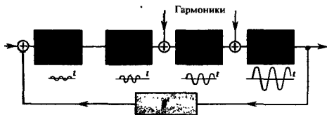
Рис. 14.2. Подавление высших гармоник в многоступенчатом усилителе с ООС
