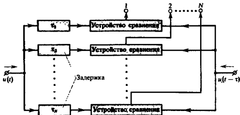
Рис. 3.3. Устройство для измерения времени задержки сигналов
