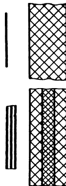
Рис. 6.3. Условное изображение изоляции в разрезе
