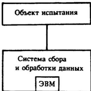
Рис. 4.27. Сосредоточенная ССО ЭД
