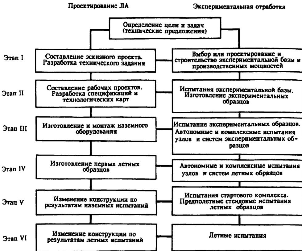
Рис. 1.2. Схема проектирования ЛА и его экспериментальной отработки
