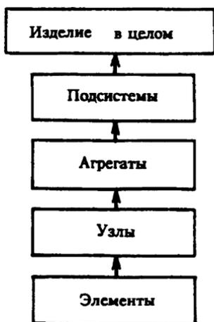
Рис.1.1 Структурная схема сложной технической системы
