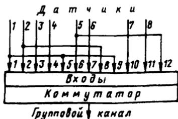
Рис. 4.31. Схема объединения входов коммутатора
