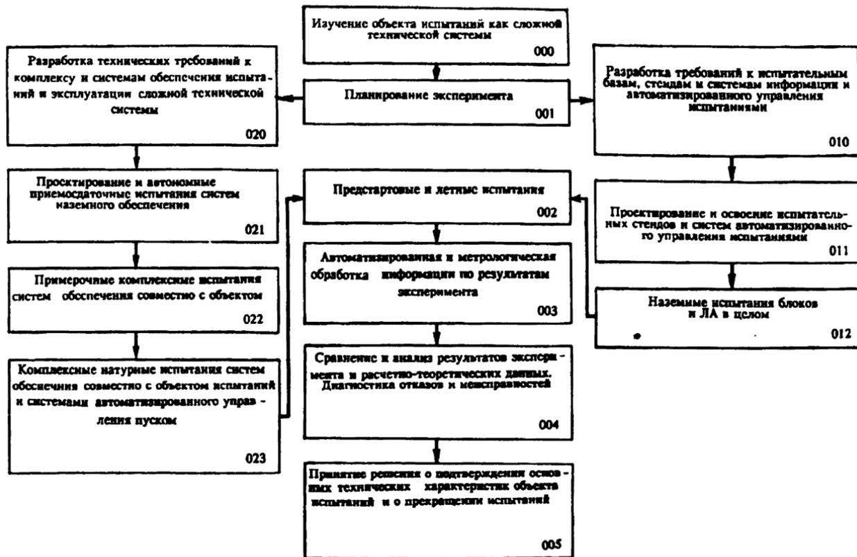
Рис. 1.3. Последовательность проведения работ по экспериментальной обработке ЛА
