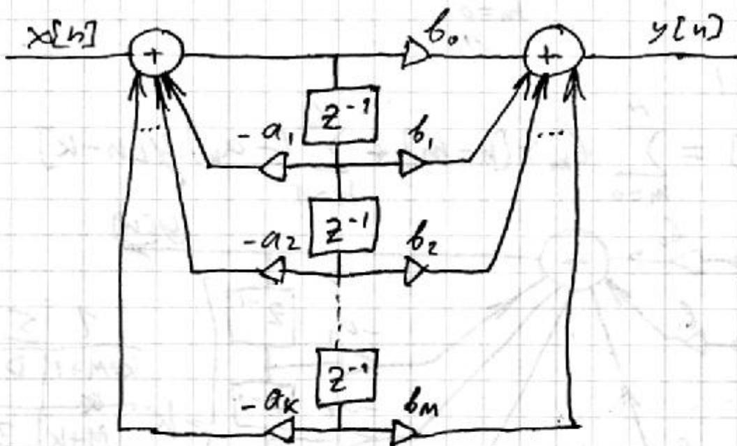
Каноническая схема ЦФ
