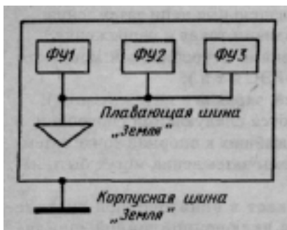
Рис. 6.15. Схема с плавающим заземлением
